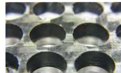
CFRTP 裏面 (アルミ + CFRTP 同時穿孔) S=2660rpm F=37mm
