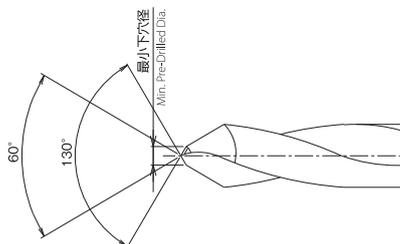
先端角60°の外径φ3～φ12品は、センタリング時のチゼルエッジ潰れを防止するため、最小下穴径より内側の中心部のみ130°になっています。
