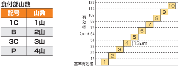
タフレットの精度番号の有効径位置
