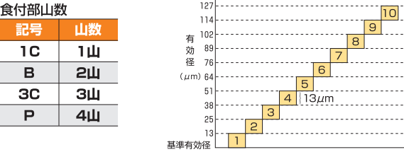
タフレットの精度番号の有効径位置
