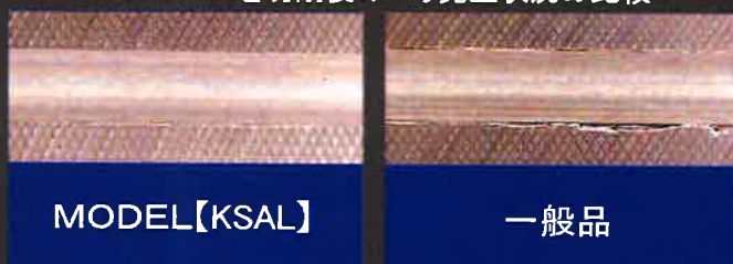
A6061-T6を切削後のバリ発生状況の比較
