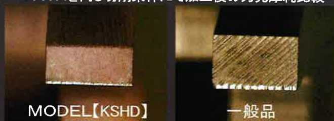
SUS304を同じ切削条件にて加工後の刃先摩耗比較
