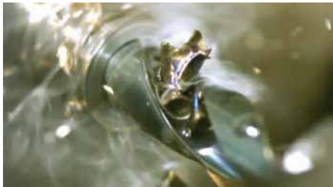
切くず詰まり発生 Chip jamming
